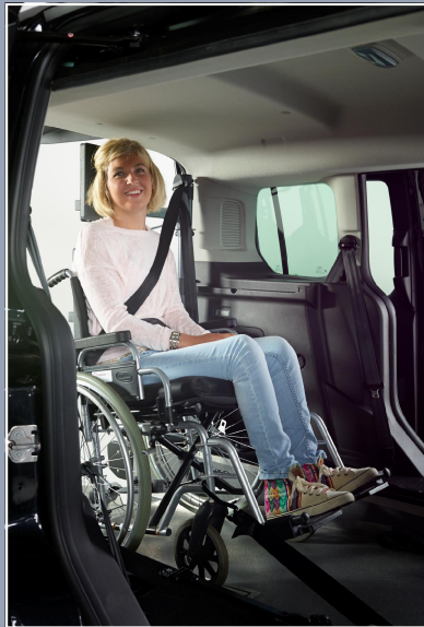
Système Easy-Flex breveté, la rampe se rabat et devient le fond de votre coffre.
