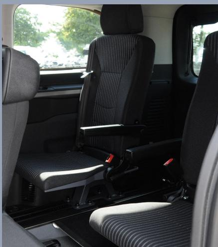
OPTION : 1 ou 2 sièges rabattables pivotants contre les parois permettent de retrouver une configuration jusqu'à 7 ou 8 places.
